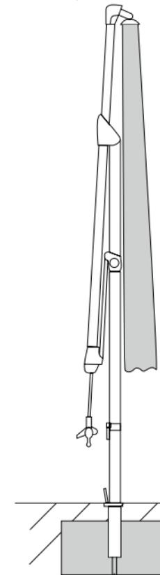
Vysunutí volného ramene slune níku a otev ení
